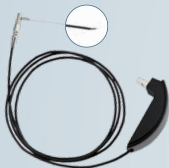
Игла USB-термощупа имеет диаметр всего 1 мм, длину 60 мм и острый скошенный срез – это позволяет отслеживать температурную динамику в готовящемся продукте, не нарушая при этом вакуум в пакете.
